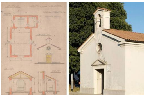
Progetto per la ristrutturazione della chiesetta di Dobbia e l'edificio in una foto attuale.
